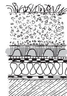
INTENSIVE DACHBEGRÜNUNG RETENTIONSdach
