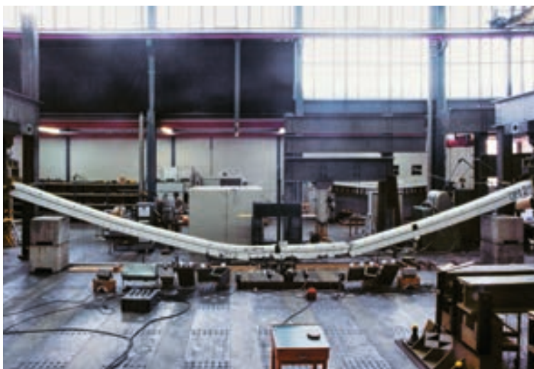
Bild 1-6: Ein Stahlbetonbalken nach mehreren Fallversuchen.
