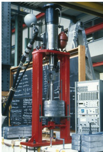
Bild 1-2: Der neuartige servohydraulische Schwingungserreger im Einsatz bei dynamischen Versuchen an Leichtbetonbalken.
