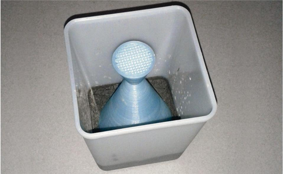
**Bild 3.4** 3D-gedruckte Positivform (hellblau)
