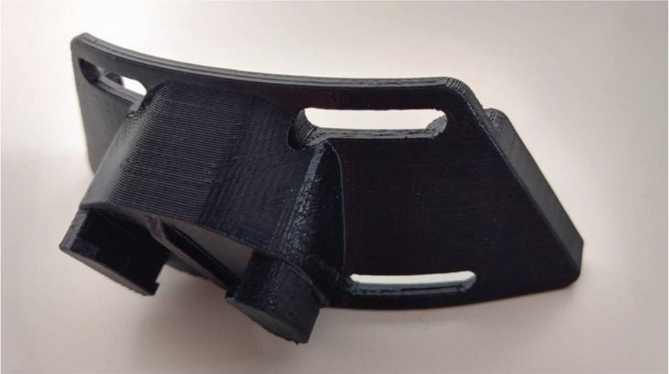
**Bild 3.3** FLM-gedruckter Prototyp (Druckzeit: 40 Minuten)
