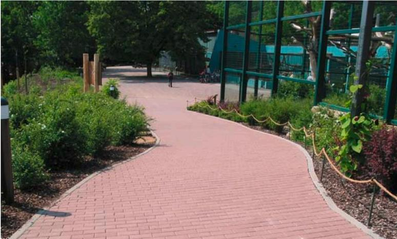
**Bild 4:** Gehweg mit seitlicher, taktil erfassbarer Gehbahnbegrenzung (Materialwechsel: Betonpflaster/Vegetationskante)
