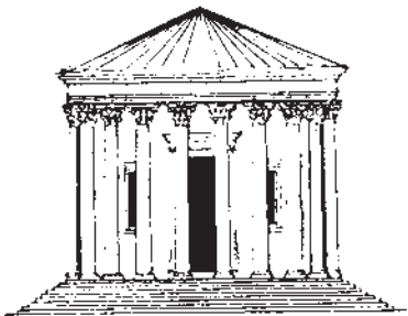
Rom, Rundtempel am Tiber, sog. Vesta-Tempel, E. 2. Jh. Cella von 20 korinthischen Säulen umgeben. Kapitelle erst später aufgesetzt: ihr \varnothing entspricht nicht den Säulenschäften.
