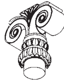
Äolisches Kapitell, archaischer Tempel von Neandrea in Äolis/NW-Kleinasien, um 600 v. Chr., Sonder- oder Vorform des ionischen Kapitells: über herabhängenden Blättern 2 Voluten und Palmette
