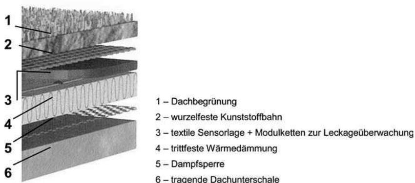
**Bild 5-108** Schichtenaufbau für eine Dachbegrünung auf einer oberen Dachabdichtung
