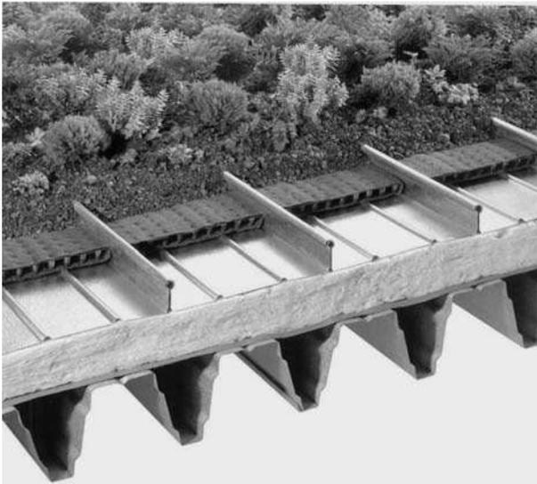
**Bild 5-109** Dachbegrünung auf einem wärmegeädämmten zweischaligen Dach mit einer Deckung aus Aluminium-Stehfalzelementen
